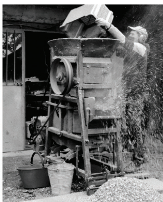
↑ Antica macchina per battere le castagne dopo l'essiccazione.
